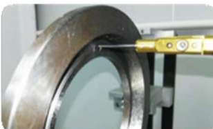
Đo phần đường ray
